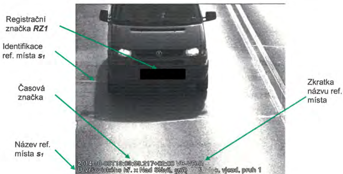
Obr. 5: Snímek vozidla při vjezdu do měřeného úseku
